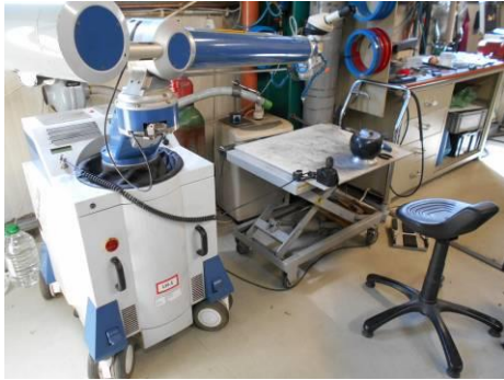
2.5.2. 1 Fotó Lézer hegesztőgép, lézerhegesztő munkahely, huzal, munkaasztal munkadarab forgatóval 71
