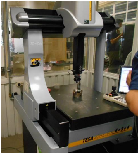
2.4.2. 1. Fotó: állványos, konzolos mozgatás légcsapályazással
