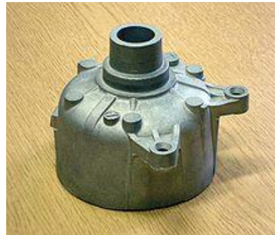
2.1.2. ábra. Nyomásos öntéssel készült alkatrész 47
