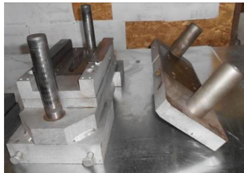
2.5.1. 2. fotó Alsó, felső szerszámtest bélyeg és vágólap nélkül
