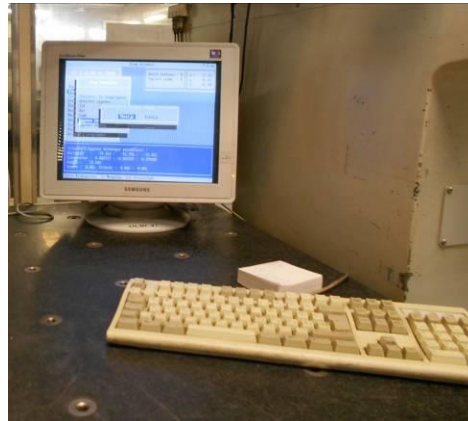
2.4.2. 3. Fotó: furat ellenőrzés 3 pont felvétellel, számítógépes kiértékelés
