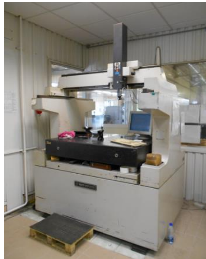
2.4.2. 2. Fotó: lineáris, vezetékes konzol mozgatású mérőgép
