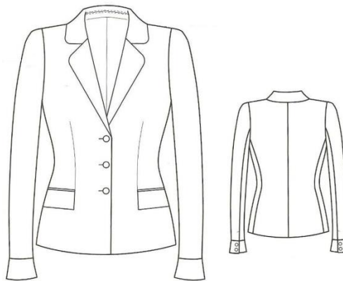
87. ábra Csapott fazonú női blézer gyártmányrajza
