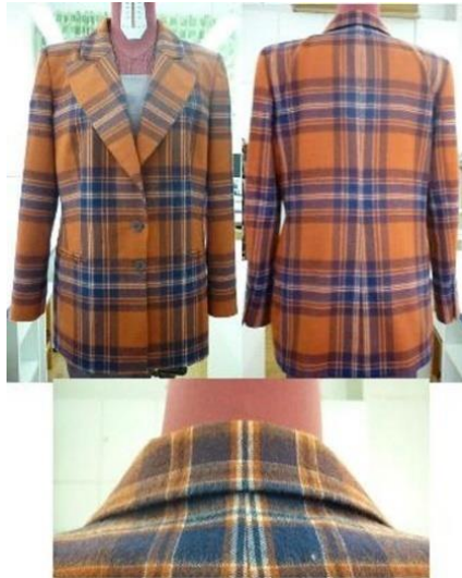
58. ábra Kockás anyagból készült női blézer mintaillesztése
